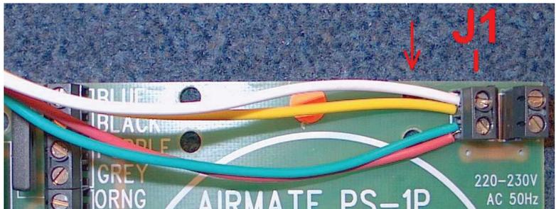
Le voyant rouge (flèche) spécifie le point (2 trous) où les fils doivent être montés à la carte électronique avec un serre-câble.
